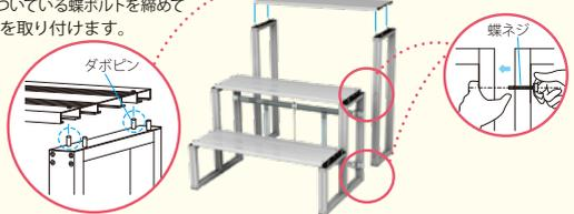
3 脚部左右の接続は、脚部と脚部の間に段板をのせておこないます。これを繰り返して接続していきます。
