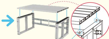
3 脚部前後の接続は、各脚部についている蝶ボルトを締めて接続します。脚部左右の接続は、脚部と脚部の間に天板をのせておこないます。
