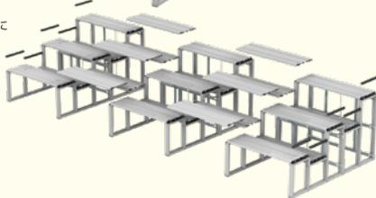
4 全体の接続が完了したら観覧席の両サイドにエンドゴムキャップを取り付けて完成です。
