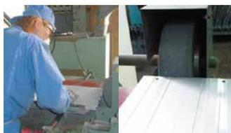
「バフ研磨」加工とは、磨いて角を取り、ツヤをだす加工です。バリ、面取りが必要な箇所（段板・天板等の切断面積の大きい箇所）は削る加工（ヤスリ垢）が一般的です。当社では、お客様の安全を第一と考え、製品全ての段板・天板に「バフ研磨」加工を施しています。フェルトや柔らかい布、ポリッシングパッド、フラップバフなどの布製の研磨製品を使って磨きこむ手間のかかる工程を行っております。マイクロレベルで磨かれた鏡面状のその製品は、手触りが優しく安全にお取り扱いいただけるこだわりの製品です。
